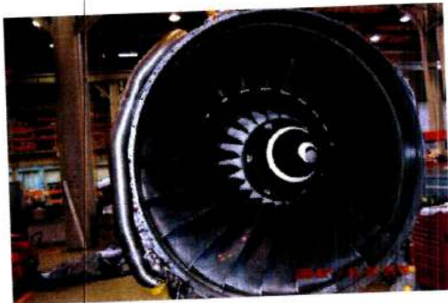
Fig. II: Fan blades before removal
